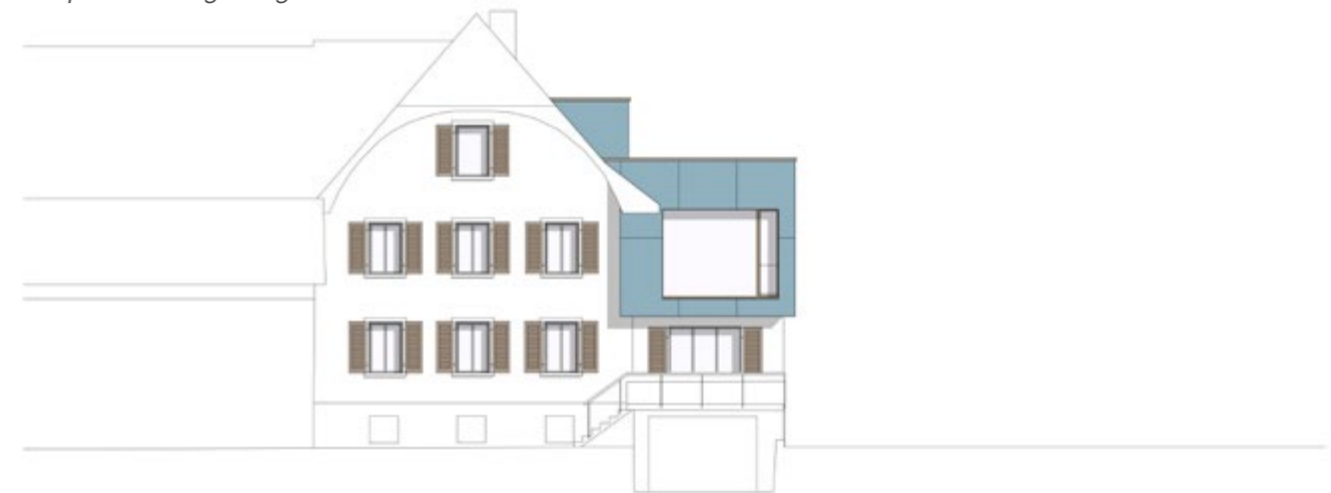
südfassade mit neuer aufstockung
